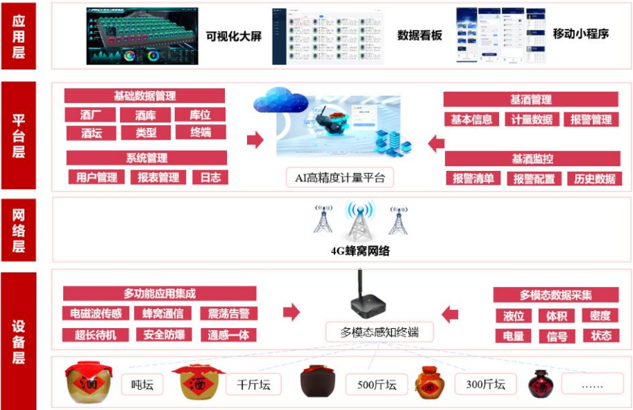
图3 基酒精准计量产品架构图
