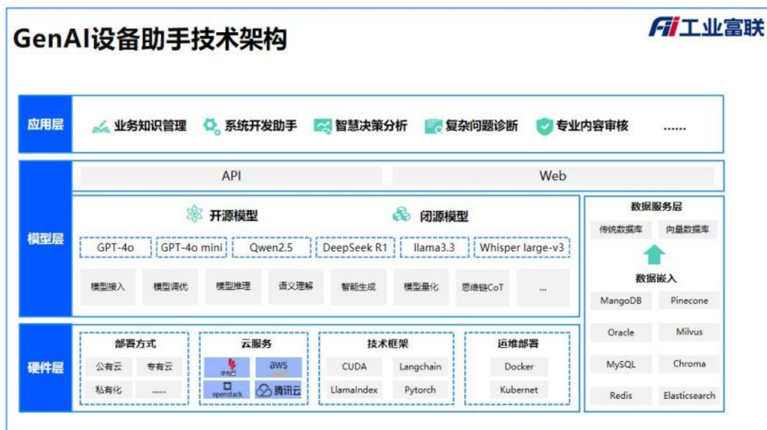
图 6：GenAI 设备助手技术架构
