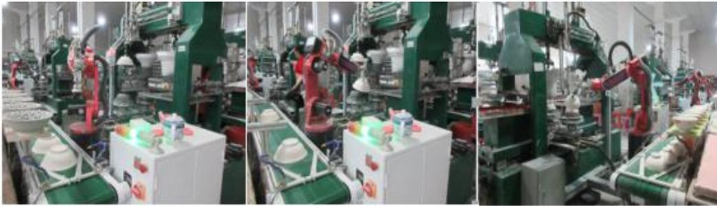
图 11-3 机器人自动印彩
