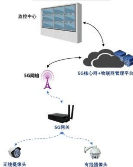
图 21-9 系统总体架构图
