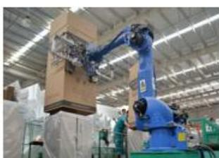
基于5G数据传输的协同制造：打U机器人
