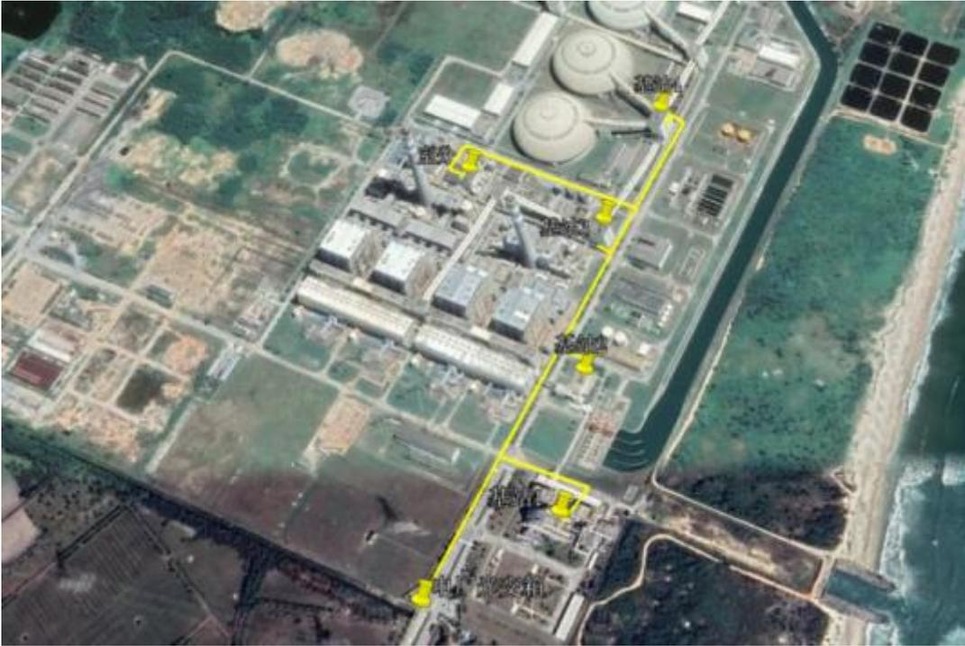
图 12-5 电厂内新建光缆路由图
