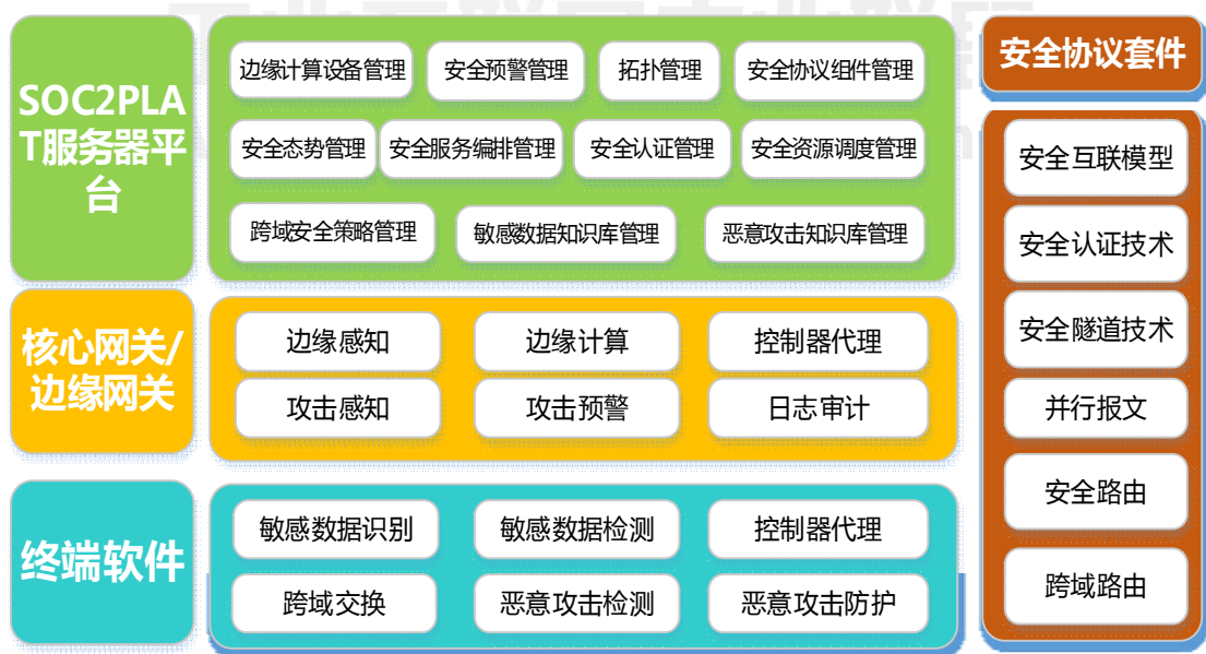
图 1 边缘计算敏感数据安全防护系统整体架构
