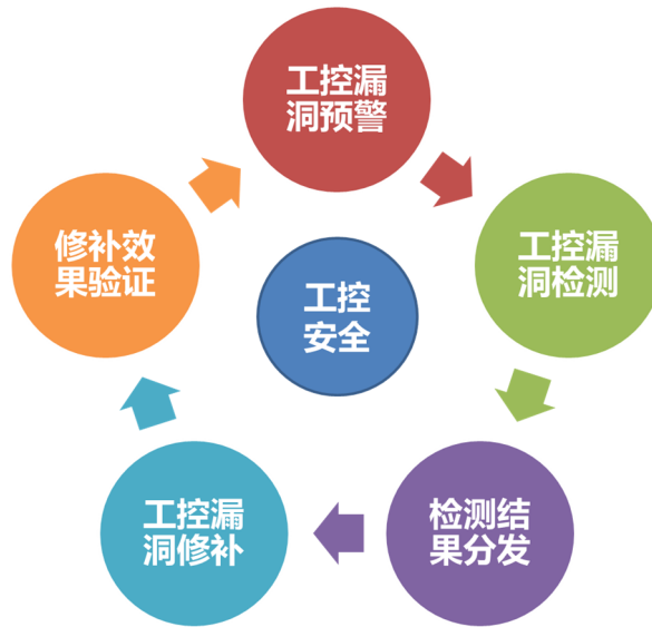
图 31 工控漏洞管理流程
